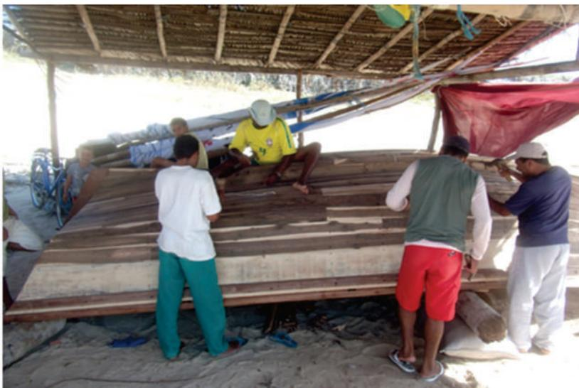
**Figura 6.** Pescadores construindo embarcação tipo canoa.
