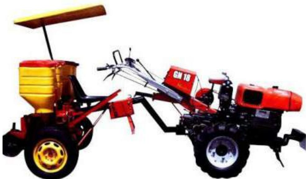
**Figura 10.** Semeadora para microtratores utilizadas na agricultura familiar.
