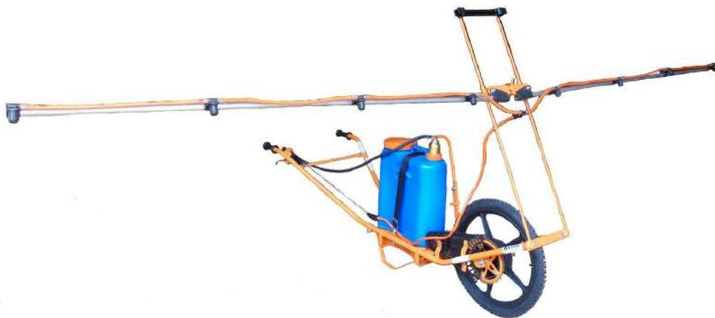
**Figura 2.** Pulverizador agrícola para pequenos agricultores.
