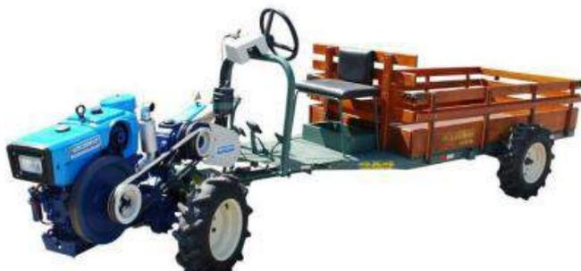
**Figura 7.** Carreta transportadora acoplada ao trator de rabiças
