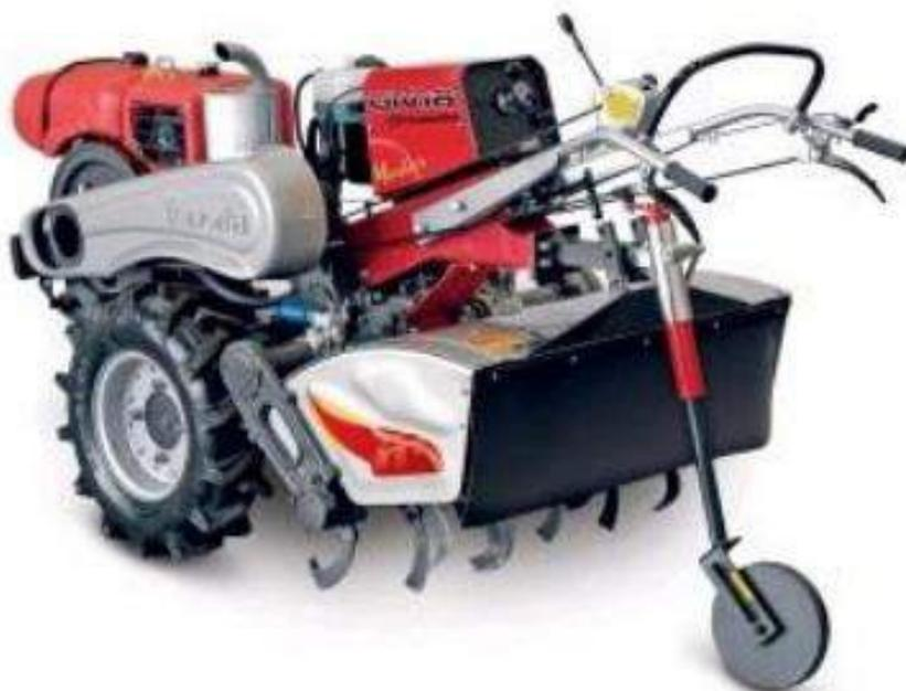
**Figura 11.** Enxada rotativa no preparo do solo com tratores de rabiças.
